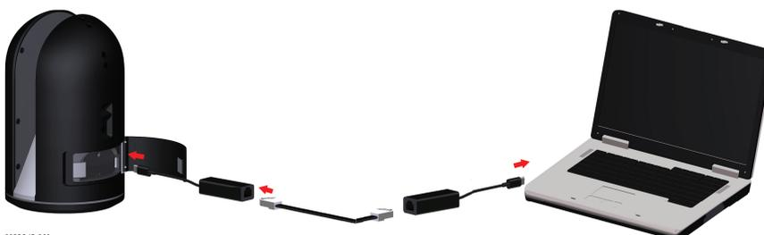
☞ コンピューティングデバイスがドッキングステーションを使用してインターネットに接続している場合、このインターネット接続は BLK360 に接続するために切断されます。
